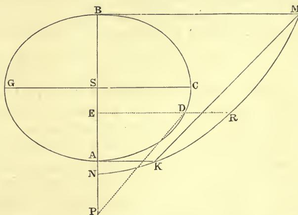
Sit autem sphæroidis centrum  $S$  & semidiameter maxima  $SC$ : & vis, qua sphærois trahit corpus  $P$ , erit ad vim, qua sphæra diametro  $AB$  descripta trahit idem corpus, ut  $\frac{AS \times CSq - PS \times KMRK}{PSq + CSq - ASq}$
