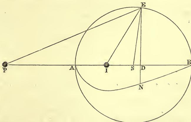
cata ratione distantiarum, attractiones in *I* & *P* erunt ad invicem ut *SP* quad. ad *SA* quad.: Si in quadruplicata, ut *SP* cub. ad *SA* cub. Unde cum attractio in *P*, in hoc ultimo casu, inventa fuit reciproce ut *PS* cub.  $\times$  *PI*, attractio in *I* erit reciproce ut *SA* cub.  $\times$  *PI*, id est (ob datum *SA* cub.) reciproce ut *PI*. Et similis est progressus in infinitum. Theorema vero sic demonstratur.
