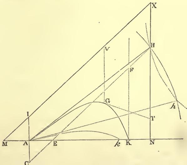
*Reg. 3.* Si tam angulus  $NAH$ , quam corporis velocitas in  $A$ , gravitasque acceleratrix servetur, & proportio resistantiæ in  $A$  ad gravitatem motricem augeatur in ratione quacunque; augebitur proportio  $AH$  ad  $AI$  in eadem ratione, manente parabolæ prædictæ latere recto, eique proportionali longitudine  $\frac{AHq}{AI}$ : & propterea
