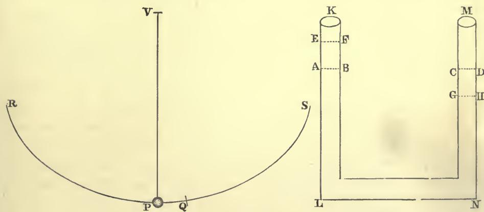
in crure *KL* ascendet ad altitudinem *EF*, descenderit aqua in crure *MN* ad altitudinem *GH*. Sit autem *P* corpus pendulum, *VP* filum, *V* punctum suspensionis, *RPQS* cyclois quam pendulum describat, *P* ejus punctum infimum, *PQ* arcus altitudini *AE* æqualis.
