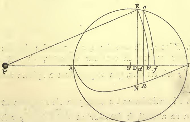
meras æquales  $Dd$ , & sphæræ totam dividi in totidem laminas sphæricas concavo-convexas  $EFFe$ ; & erigatur perpendicularum  $dN$ . Per theorema superius vis, qua lamina  $EFFe$  trahit corpusculum  $P$ , est ut  $DE \times Ff$  & vis particulæ unius ad distantiam  $PE$  vel  $PF$ .
