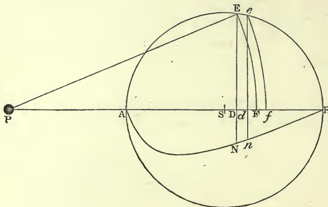
*Corol.* 1. Hinc si vis centripeta, ad particulas singulas tendens, eadem semper maneat in omnibus distantiis, & fiat  $DN$  ut  $\frac{DEq \times PS}{PE}$ ; erit vis tota, qua corpusculum a sphæra attrahitur, ut area  $ANB$ .
