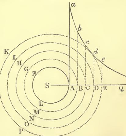
*Corol.* 2. Si fluidum in vase cylindrico longitudinis infinitæ contineatur, & cylindrum alium interiore contineat, revolvatur autem cylindrus uterque circa axem communem, sintque revolutionum tempora ut ipsorum semidiametri, & perseveret fluidi pars unaquæque in motu suo : erunt partium singularum tempora periodica ut ipsarum distantia ab axe cylindrorum.
