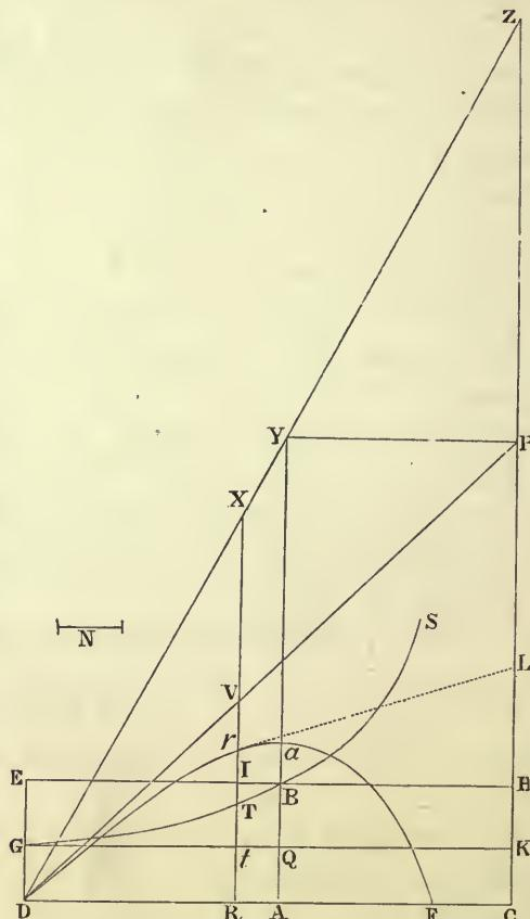
$\frac{tG T}{N}$ , vel, quod perinde est, cape  $Rr$  æqualem  $\frac{G T I E}{N}$ ; & projectile tempore  $DR TG$  perveniet ad punctum  $r$ , describens curvam lineam  $DraF$ , quam punctum  $r$  semper tangit, perveniens autem ad maximam altitudinem  $a$  in perpendiculo  $AB$ , & postea semper appropinquans ad asymptoton  $PC$ . Estque velocitas ejus in punto quovis  $r$  ut curvæ tangens  $rL$ . *Q.E.I.*
