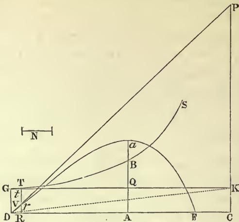
secundo  $DC$  in  $A$ , ut sit  $CP \times AC$  ad  $DP \times DA$  in eadem illa ratione gravitatis ad resistantiam, dabitur punctum  $A$ . Et inde datur curva  $DraF$ .
