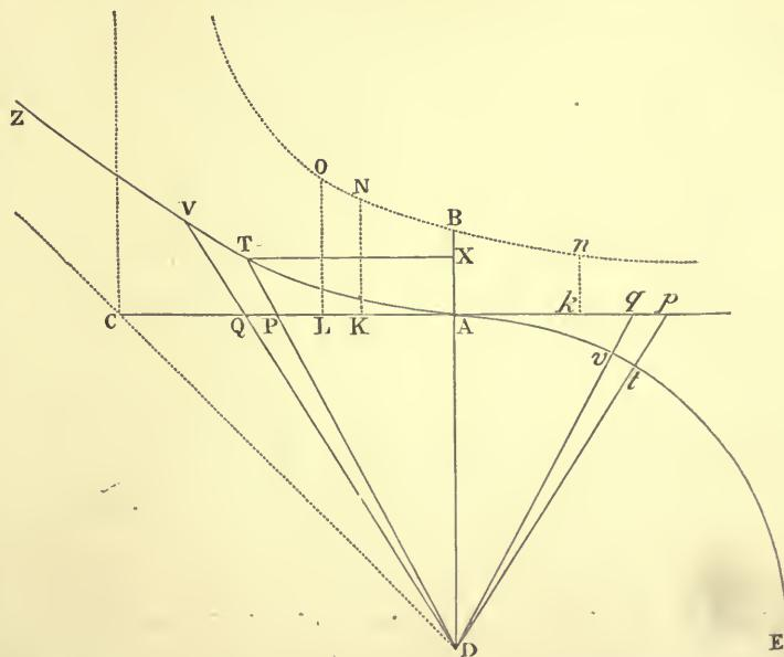
$-TXq$  est  $ADq$ , & per hypothesisin  $APq$  est  $AD \times AK$ . Ergo particulæ sunt ad invicem ut  $ADq$  ad  $ADq - AD \times AK$ ; id est, ut  $AD$  ad  $AD - AK$  seu  $AC$  ad  $CK$ : ideoque sectoris particula  $TDV$  est  $\frac{PDQ \times AC}{CK}$ ; atque ideo ob datas  $AC$  &  $AD$ , ut  $\frac{PQ}{CK}$ , id est, ut incrementum velocitatis directe, utque vis generans
