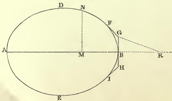
Quod si figura  $DNFG$  ejusmodi sit curva, ut si ab ejus punto quovis  $N$  ad axem  $AB$  demittatur perpendicularum  $NM$ , & a punto dato  $G$  ducatur recta  $GR$  quæ parallela sit rectæ figuram tangent in  $N$ , & axem productum secet in  $R$ , fuerit  $MN$  ad  $GR$  ut  $GR$  cub. ad  $4BR \times GBq$ ; solidum quod figuræ hujus revolutione circa axem  $AB$  facta describitur, in medio raro prædicto ab  $A$  ver-
