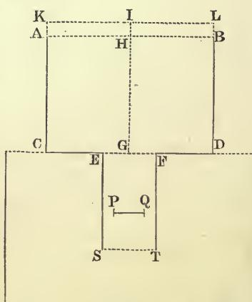
$\frac{1}{2}PQq$  ad  $EFq$  semel, & ratione  $EFq - PQq$  ad  $EFq$  bis: resistantia cylindri erit ad vim qua totus ejus motus, interea dum longitudinem L describit, vel tolli possit vel generari, ut densitas medii ad densitatem cylindri.
