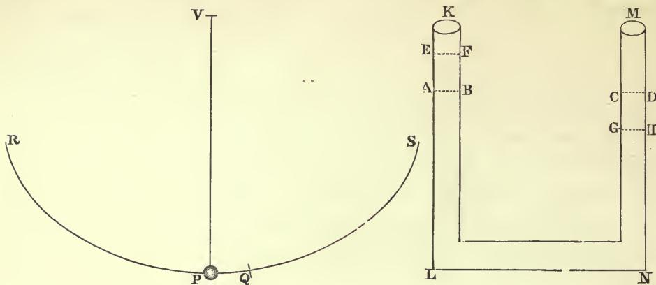
$PR$ . Vis etiam, qua pondus  $P$  in loco quovis  $Q$  acceleratur & retardatur in cycloide (per corol. prop. li) est ad ejus pondus totum, ut ejus distantia  $PQ$  a loco infimo  $P$  ad cycloidis longitudinem  $PR$ . Quare aquæ & penduli, æqualia spatia  $AE$ ,  $PQ$  describentium, vires motrices sunt ut pondera movenda; ideoque, si aqua & pendulum in principio quiescunt, vires illæ movebunt eadem æqualiter temporibus æqualibus, efficientque ut motu reciproco simul eant & redeant. *Q.E.D.*
